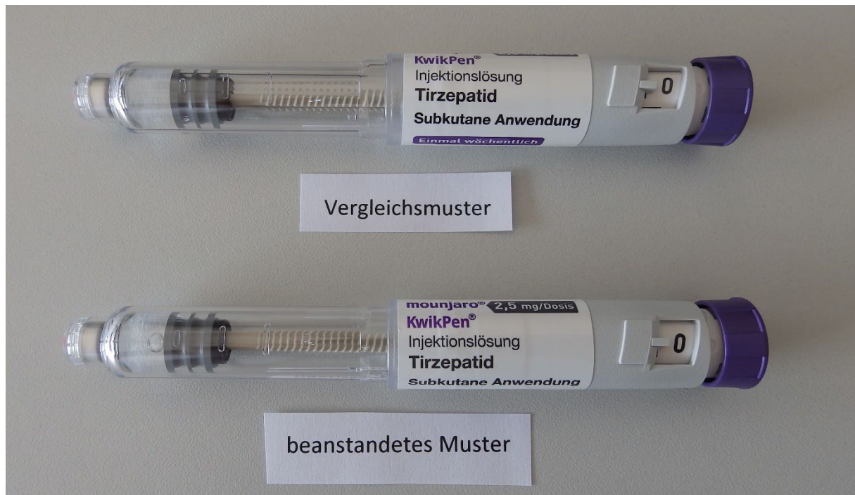
Abbildung: Restvolumen nach Entnahme von vier Dosen aus dem Vergleichsmuster und beanstandetes Muster (Foto © ZL)
